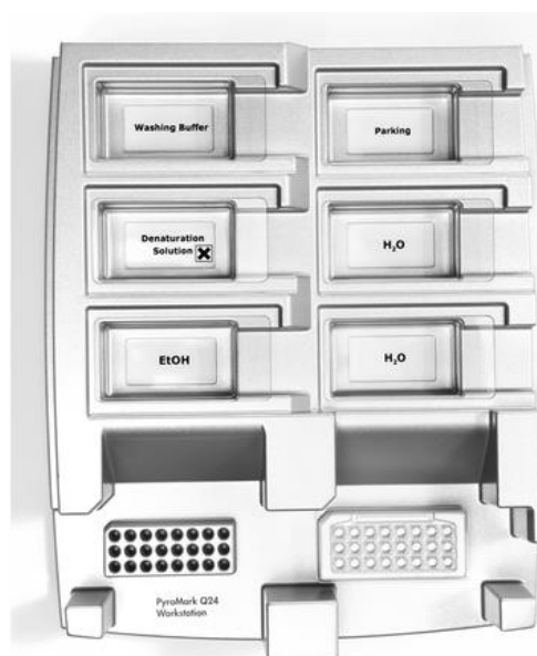
Bild 3. Placering av PCR-platta (eller remsor) och PyroMark Q24-platta på vakuumbrytaren.
