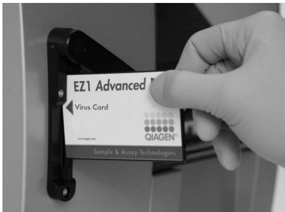
Figura 1. Setup agevolato del protocollo tramite le card EZ1 DSP. Inserimento di una card EZ1, preprogrammata con il protocollo, nello strumento EZ1.
