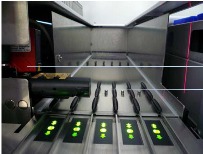
Положение сканера штрих-кодов и упора.
