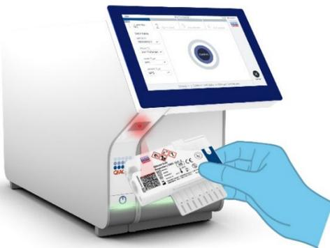
图 45.扫描 QIAstat-Dx Respiratory SARS-CoV-2 Panel Cartridge 条形码。
