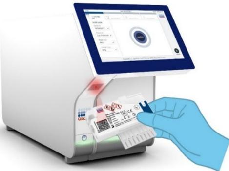
图 12.扫描 QIAstat-Dx Respiratory SARS-CoV-2 Panel Cartridge 条形码。
