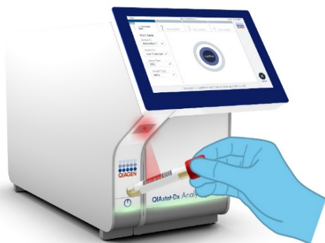
Ryc. 10. Skanowanie kodu kreskowego identyfikatora próbki.
