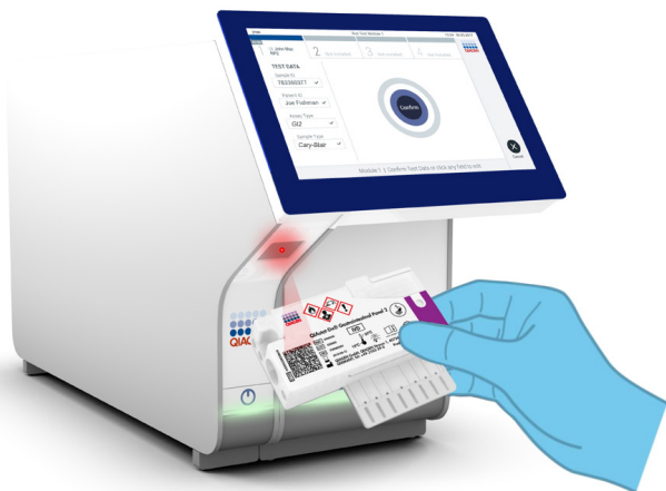
Ryc. 11. Skanowanie kodu kreskowego kasety QIAstat-Dx Gastrointestinal Panel 2 Cartridge.
