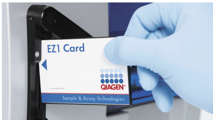
Obrázek 6. Snadné nastavení protokolů pomocí karet EZ1 DSP. Vložení karty EZ1 Card, předprogramované protokolem, do přístroje EZ1.
