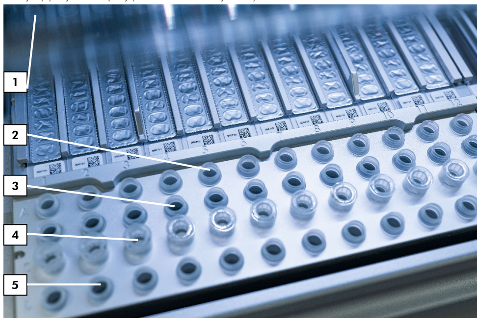
Obrázek 5. Pracovní plocha na přístroji EZ2 Connect MDx. (1) Topný blok s vloženými 2ml zkumavkami (ST) v kazetách s reagenčními (RCV) pro lůžka. (2) Zkumavky na alikvoty (ST) (2 ml) vloženy do řady A. (3) Zkumavka (ET) (1,5 ml) obsahující nosič RNA (CARRIER) a interní kontrolu (Internal Control, IC) (je-li použita) v elučním pufru (AVE), vložena do řady B. (4) Držáky jednorázových špiček (DTH) obsahující jednorázové špičky s filtrem (DFT), vloženy do řady C. (5) Eluční zkumavky (ET) (1,5 ml) vloženy do řady D.
