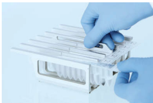
Obrázek 9. Vložení stojánu na kazety s reagensii. Samotný stojánek na kazety je označen šipkou, která označuje směr, ve kterém musejí být kazety s reagensii (RCV) vkládány.
