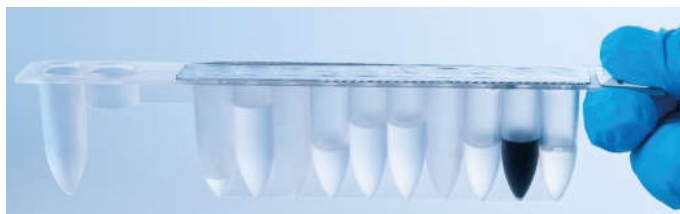
Obrázek 8. Kazeta s reagensii (RCV). Uzavřená, předem naplněná kazeta RCV ze sady EZ1 DSP Virus Kit.
