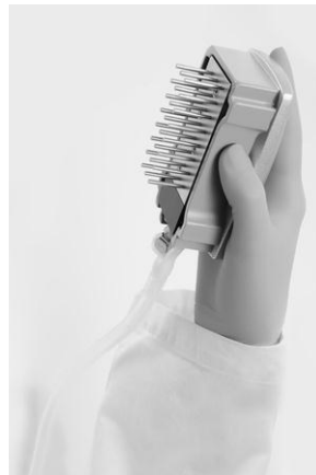
3. Ábra. A vákuum fej hátradöntése, a függőleges 90°-on túl.
