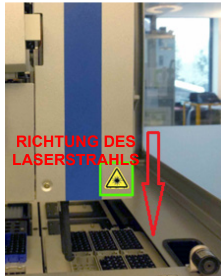
Etikett mit Warnung vor Laserlicht – Position 2 (AS)
