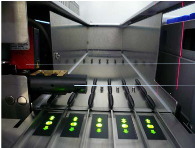
Positionen von Barcode-Reader und Abstandshalter
