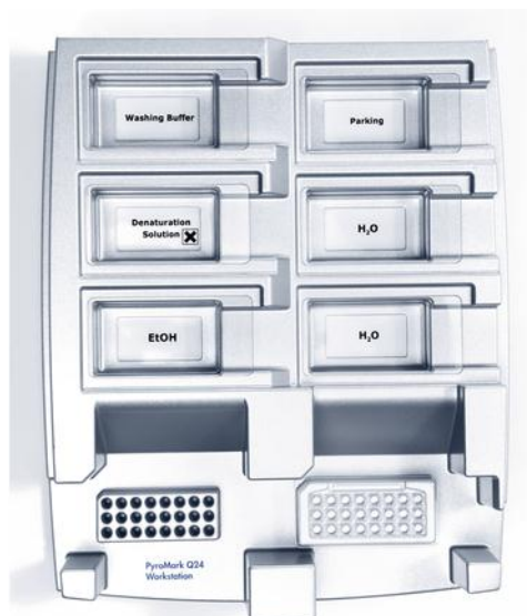
Ilustración 3. Colocación de la placa de PCR y de la placa PyroMark Q24 en la estación de vacío.
