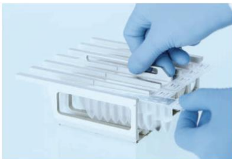
图 4. 装载试剂条载架。试剂条载架（RCV）本身标有箭头，指示试剂条必须装入的方向。
