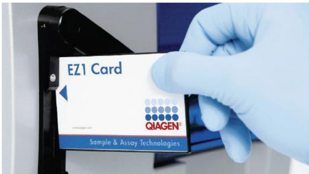
图 1：使用 EZ1 DSP 卡轻松设置规程。把 EZ1 卡（用规程进行了预编程）插入 EZ1 仪器中。
