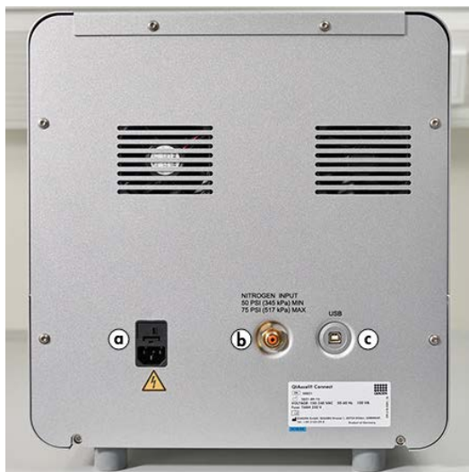
Slika 5. Priključak za napajanje (a), vanjski N2 (b) i USB priključak (c).
