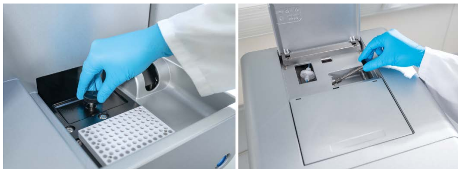
Slika 3. Skidanje transportne blokade.
