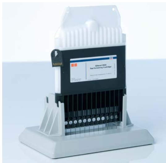
Slika 7. Inkubacija na stalku za uloške QX Cartridge Stand.
