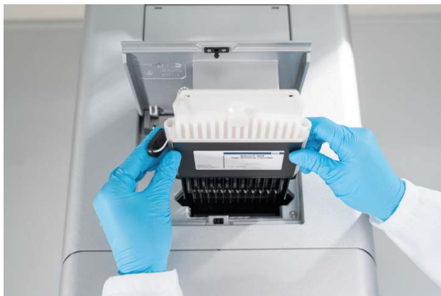
Slika 9. Postavljanje uložka s gelom QIAxcel Gel Cartridge.
