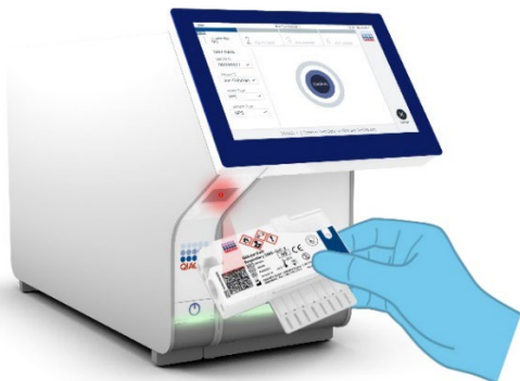
45. ábra. A QIAstat-Dx Respiratory SARS-CoV-2 Panel Cartridge kassetta vonalkódjának beszkennelése.
