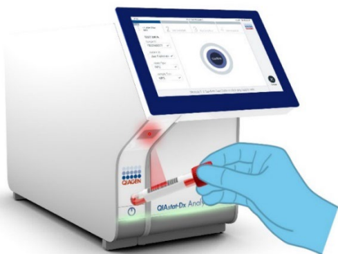
11. ábra. A mintaazonosító vonalkódjának beszkennelése.
