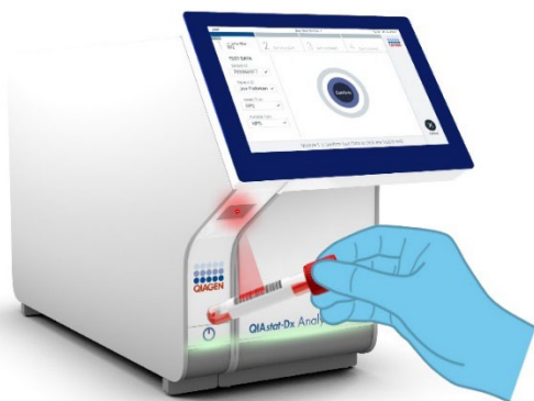
44. ábra. A mintaazonosító vonalkódjának beszkenelése.
