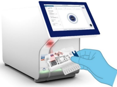
12. ábra. A QIAstat-Dx Respiratory SARS-CoV-2 Panel Cartridge kazetta vonalkódjának beszkenelése.
