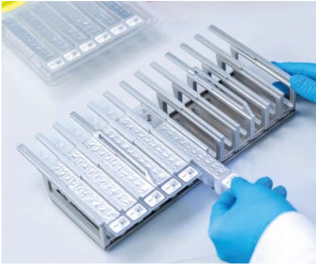
Kuva 3. Reagenssikasettiteline. Kasettitelineen nuoli osoittaa reagenssikasettien (RCB) asetussuunnan.
