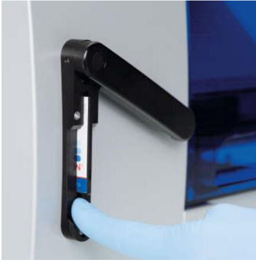
Kuva 7. EZ1-kortti on asetettu oikein EZ1-laitteen korttipaikkaan.
