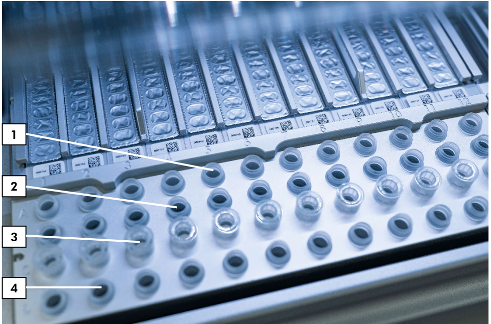
Kuva 5. EZ2 Connect MDx -laitteen työalusta. (1) Näyteputket (sample tubes, ST) (2 ml) on asetettu riville A. (2) Tyhjä tai valinnainen: 80-prosenttista etanolia sisältävä putki (2 ml) valinnaista pesuvaihetta varten on asetettu riville B. (3) Kertakäyttöisiä suodatinkärkiä (disposable filter-tips, DFT) sisältävät kertakäyttökärkien pidikkeet (disposable tip holders, DTH) on asetettu riville C. (4) Eluutioputket (elution tubes, ET) (1,5 ml) on asetettu riville D.
