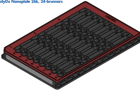
Bild 1. QIAcuityDx Nanoplate innehåller raderna A–H och kolumnerna 1–3.
