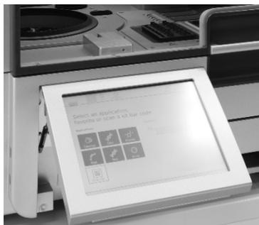
Figure 16. Écran tactile escamotable du QIAcube Connect MDx.
