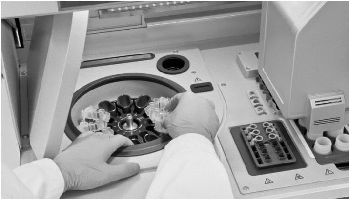
Figure 21. Chargement de la centrifugeuse sur les instruments QIAcube. Chargez les adaptateurs de rotor assemblés dans les godets de la centrifugeuse (QIAcube Connect MDx illustré ici).
