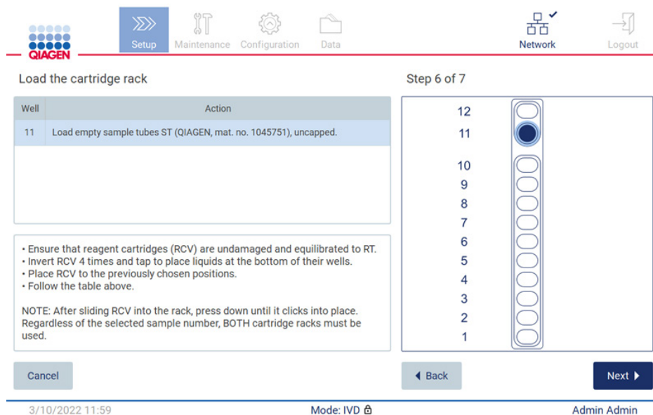
Attēls 113. Load the cartridge rack (Kasetņu statīva ievietošana).
