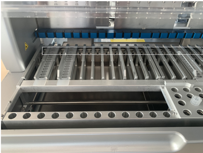
Attēls 16. Apsildāmas pozīcijas kasetņu statīvā (atzīmētas ar baltu rāmi).
