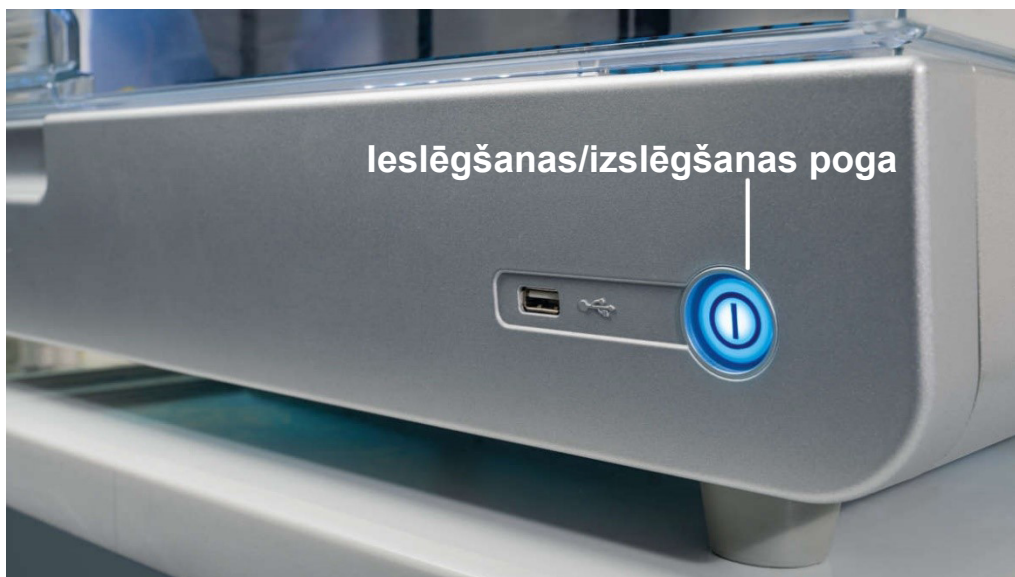
Attēls 5. Ieslēgšanas/izslēgšanas pogas atrašanās vieta.
