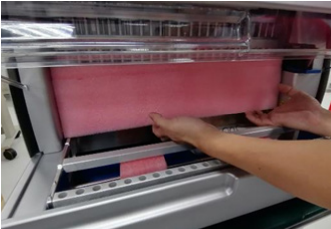
Attēls 21. Transportēšanas fiksators.
