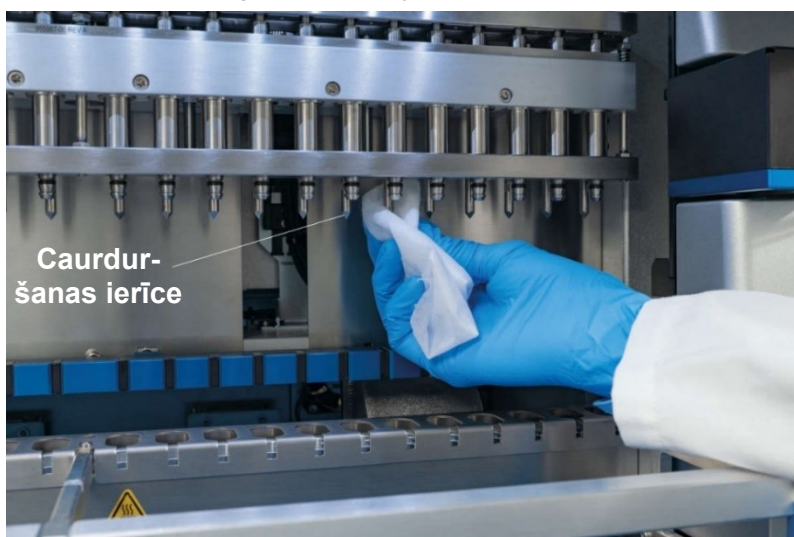
Attēls 147. EZ2 caurduršanas ierīces tīrīšana.
