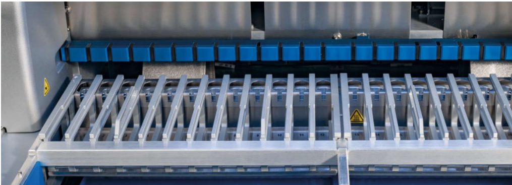
Kuva 12. Poistettava kasettiline laitteen sisällä.
