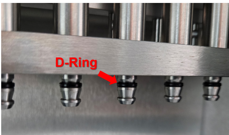
Kuva 177. Kärkisovitin, D-rengas korostettu.
