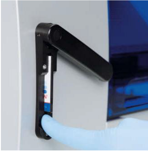
Afbeelding 7. EZ1-kaart volledig ingevoerd in EZ1 Card-sleuf.
