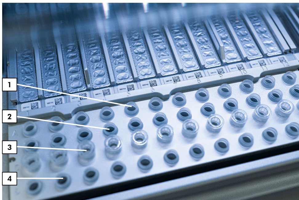
Afbeelding 5. Werktafel van een EZ2 Connect MDx-instrument. (1) Monsterbuisjes (ST) (2 ml) geladen in rij A. (2) Leeg of optioneel: Buisje (2 ml) met 80% ethanol voor optionele wasstap, geladen in rij B. (3) Wegwerptiphouders (DTH) met wegwerptipfilters (DFT) geladen in rij C. (4) Elutiebusjes (ET) (1,5 ml) geladen in rij D.
