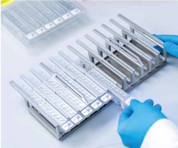
Afbeelding 3. Reagenscartridgerek. Het cartridgerek zelf heeft een pijl om de richting aan te geven waarin reagenscartridges (RCB) moeten worden geladen.
