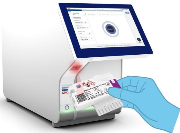
**Figura 11. Scansione del codice a barre della QIAstat-Dx Gastrointestinal Panel 2 Cartridge.**
