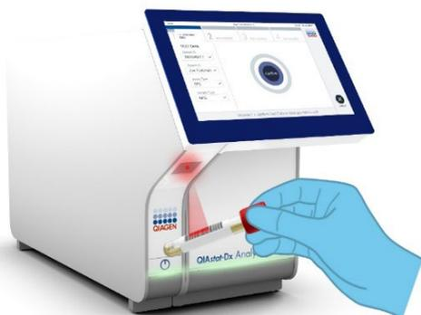
**Figura 10. Scansione del codice a barre dell'ID campione.**
