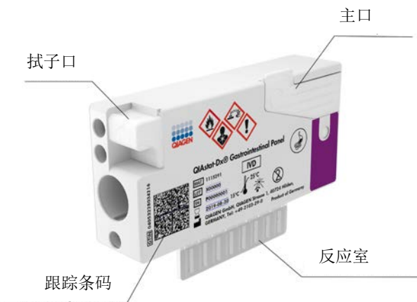
图 1. QIAstat-Dx Gastrointestinal Panel Cartridge 布局及其功能。
