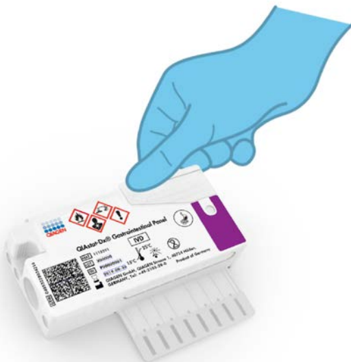
Ryc. 10. Zamykanie pokrywy głównego portu.
