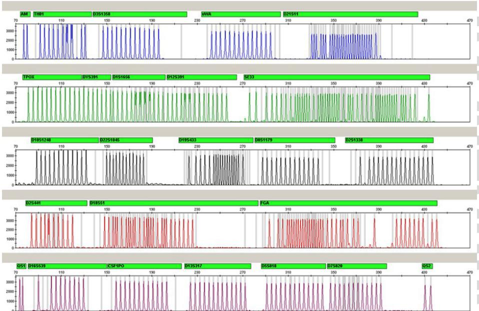
**Figura 7. Electroforetoqramo de la escalera alélica 24plex analizada en un Applied Biosystems 3500 Genetic Analyzer.** La escalera alélica incluye 2 alelos para cada sensor de calidad (QS1 y QS2). Esto permite la llamada automatizada de los picos de QS para el análisis de la muestra.
