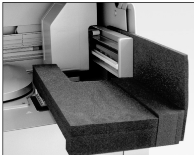
Ochranná pěnová vložka vložená mezi odstředivku a robotické rameno.
