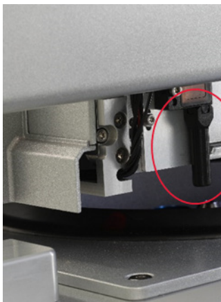
Černý kolimátor paprsku ultrazvukového senzoru (viz červený kruh).
