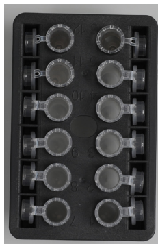
Víčka zkumavek na vzorky musí být bezpečně umístěna ve otvorech na okraji stojanu třepačky
