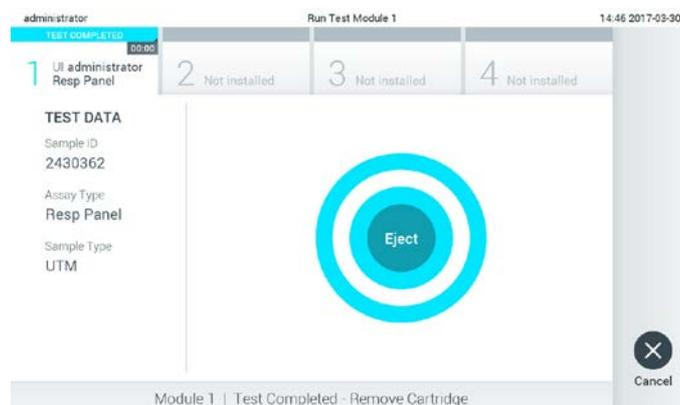
Pedido de ejeção do cartucho usado após a execução de um teste.
