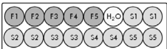
Figura 6: Configuração da placa sugerida para um ensaio. S: Amostra de ADNc; F1–5: Padrões PML-RARA bcr1; C1–3: Padrões ABL; H 2 O: controlo de água.
