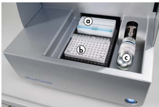
Figur 4. Plassering av bufferbrettholder (a), prøveplateholder (b) og N 2 -port (c).
