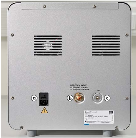
Figur 5. Strømtilkobling (a), ekstern N 2 (b) og USB-port (c).
