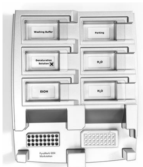
Ilustración 2. Colocación de la placa de PCR (o tiras) y de la placa PyroMark Q24 plate en la estación de vacío.
