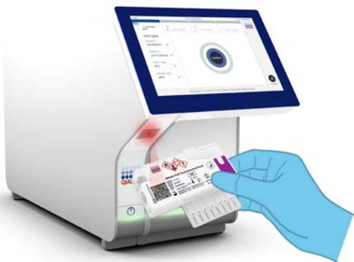
Obrázok 13. Skenovanie čiarového kódu kazety QIAstat-Dx Gastrointestinal Panel Cartridge.
