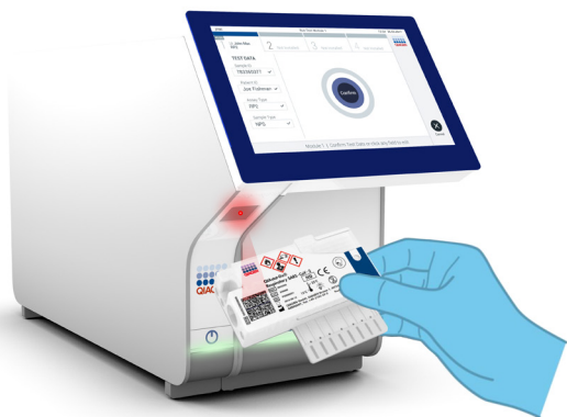
Figur 25. Scanning af stregkode på QIAstat-Dx Respiratory SARS-CoV-2 Panel Cartridge.
