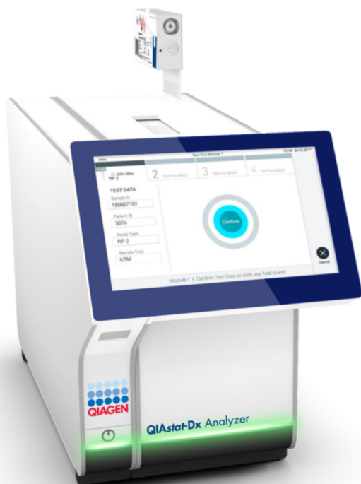
Figur 28. Indsætning af QIAstat-Dx Respiratory SARS-CoV-2 Panel Cartridge i QIAstat-Dx Analyzer 1.0.
