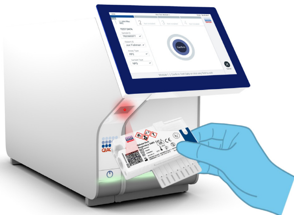
Figur 12. Scanning af strekcode på QIAstat-Dx Respiratory SARS-CoV-2 Panel Cartridge.
