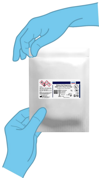
Figur 5. Åbning af QIAstat-Dx Respiratory SARS-CoV-2 Panel Cartridge.
