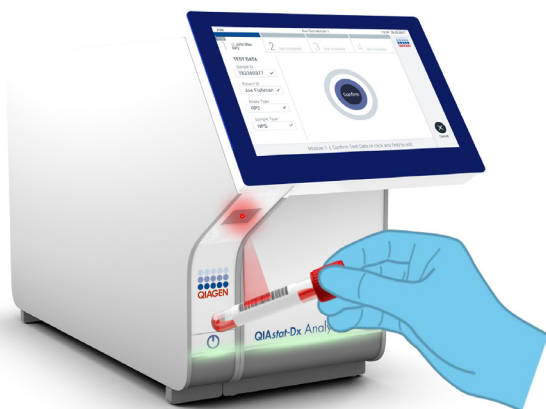
Figur 24. Scanning af prøve-ID-stregkode.
