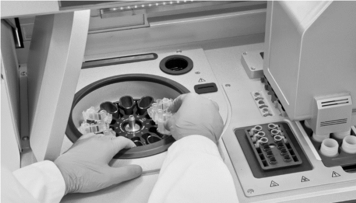
Hình 21: Nạp máy ly tâm vào QIAcube Connect MDx. Nạp các bộ điều hợp rôto đã lắp ráp vào thùng máy ly tâm.
