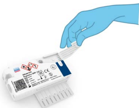
Ryc. 19. Otwieranie pokrywy próbek portu głównego.
