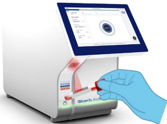
Ryc. 11. Skanowanie kodu kreskowego id. próbki.
