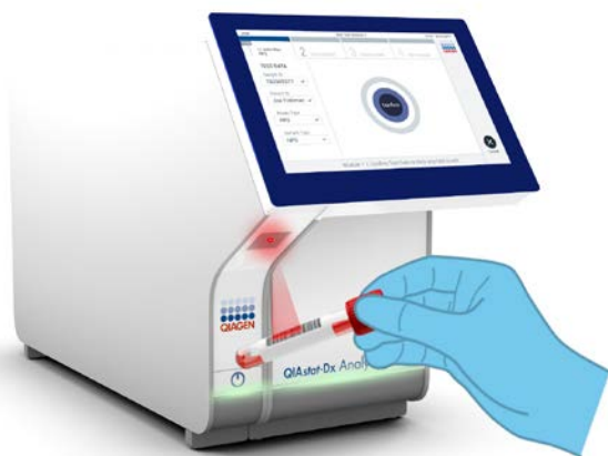
Ryc. 24. Skanowanie kodu kreskowego id. próbki.
