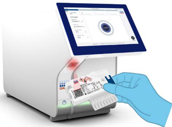
Ryc. 12. Skanowanie kodu kreskowego kasety QIAstat-Dx Respiratory SARS-CoV-2 Panel Cartridge.
