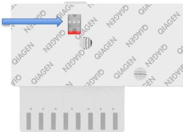
Afbeelding 4. Inspectievenster (blauwe pijl).
