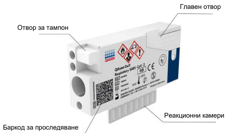
Фигура 1. Конфигурация на QIAstat-Dx Respiratory SARS-CoV-2 Panel Cartridge и нейните компоненти.
