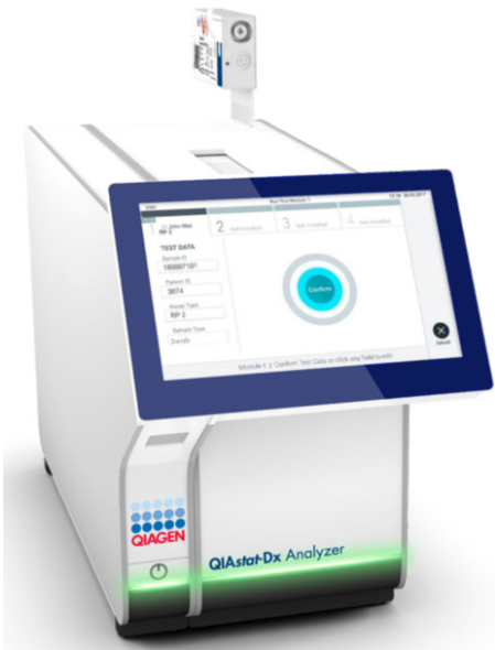
Abbildung 15. Einführen der QIAstat-Dx Respiratory SARS-CoV-2 Panel Cartridge in den QIAstat-Dx Analyzer 1.0 oder den QIAstat-Dx Analyzer 2.0.
