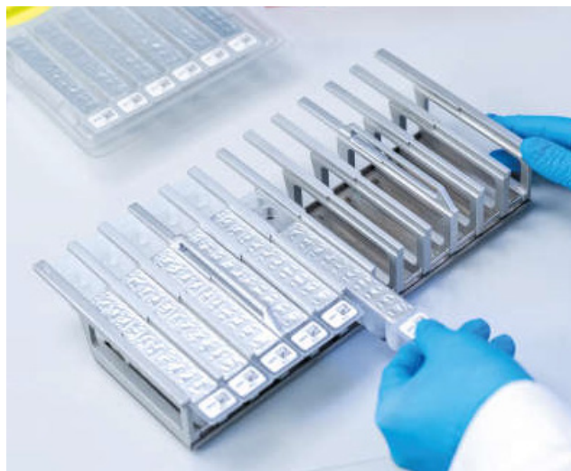
Figura 3. Gradilla de cartucho de reactivos. La gradilla de cartuchos está etiquetada con una flecha para indicar la dirección en la que deben cargarse los cartuchos de reactivos (RCB).
