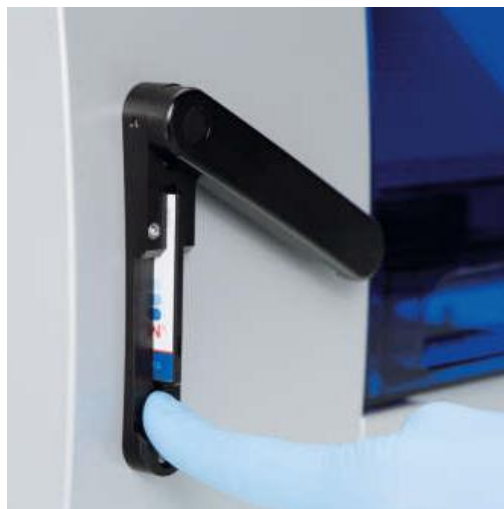
Figura 7. Tarjeta EZ1 Card insertada por completo en la ranura para la tarjeta EZ1 Card.
