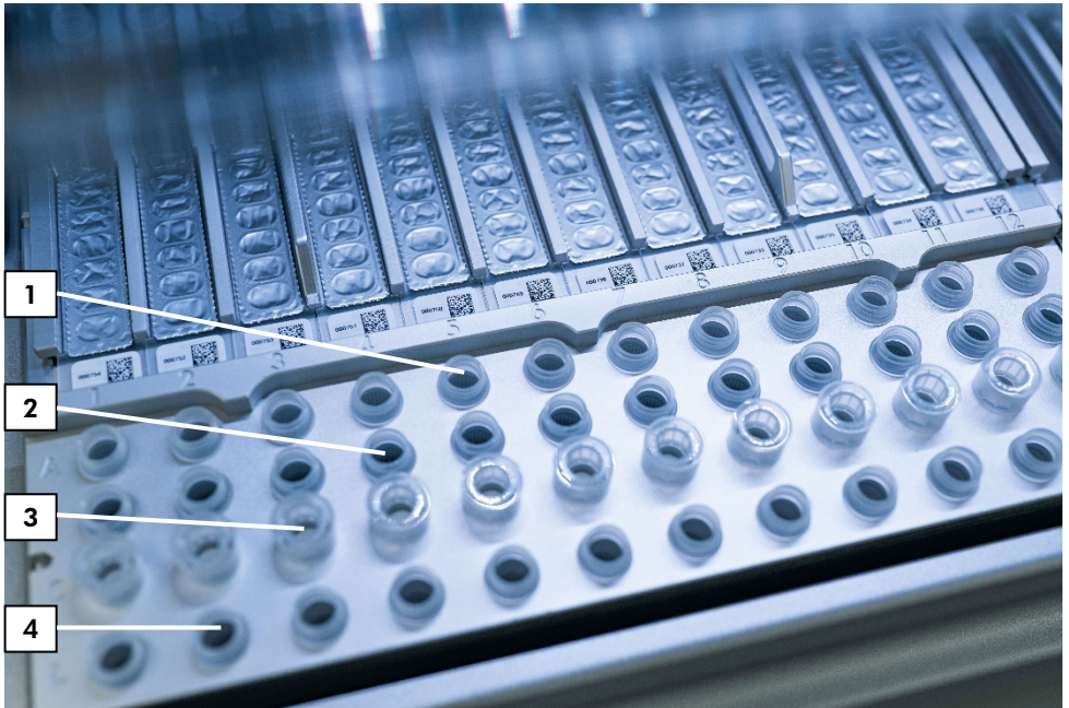
Figura 5. Mesa de trabajo de un instrumento EZ2 Connect MDx. (1) Tubos de muestra (ST) (2 ml) cargados en la fila A. (2) Vacío u opcional: Tubo (2 ml) que contiene etanol al 80 % para el paso opcional de lavado, cargado en la fila B. (3) Soporte para puntas desechables (DTH) que contiene puntas con filtro desechables (DFT) cargadas en la fila C. (4) Tubos de elución (ET) (1,5 ml) cargados en la fila D.
