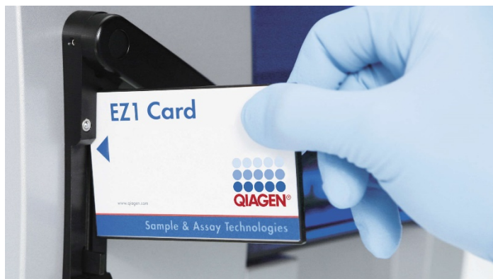
Figura 6. Facilidad de configuración del protocolo con las tarjetas EZ1 DSP Card. Inserción de una tarjeta EZ1 Card, preprogramada con el protocolo, en el instrumento EZ1.
