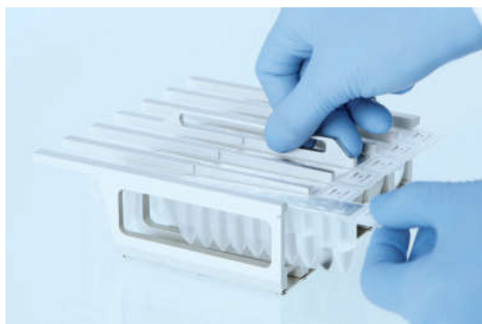
9. attēls Reaģentu kasetņu statīva ievietošana. Kasetņu statīvs ir marķēts ar bultiņu, lai norādītu virzienu, kurā jāievieto reaģentu kasetnes (RCV).
