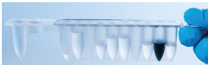
8. attēls Reaģentu kasetne (RCV). Hermētiski noslēgta, iepriekš uzpildīta EZ1 DSP Virus Kit komplekta RCV.
