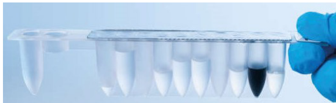
2. attēls Reaģentu kasetne (RCV). Hermētiski noslēgta, iepriekš uzpildīta EZ1 DSP Virus Kit komplekta reaģentu kasetne (RCV).
