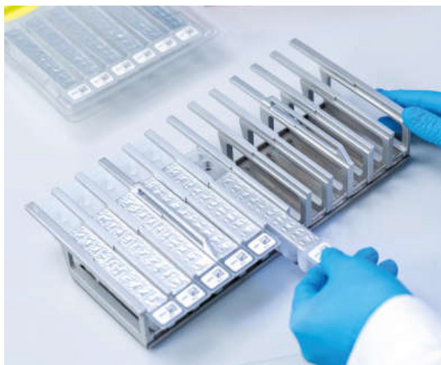
3. attēls. Reaģentu kasetnes statīvs. Kasetņu statīvs ir marķēts ar bultiņu, lai norādītu virzienu, kurā jāievieto reaģentu kasetnes (RCV).
