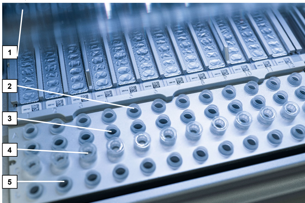
5. attēls EZ2 Connect MDx instrumenta darba plate. (1) Sildīšanas bloks ar 2 ml stobriņiem (ST), kas ievietoti reaģentu kasetnēs (RCV) lizēšanai. (2) Paraugu stobriņi (ST) (2 ml), ievietoti rindā A. (3) Stobriņš (ET) (1,5 ml), kurā ir RNS nesējvide (CARRIER) un iekšējā kontrole (Internal Control, IC) (ja tāda tiek izmantota) eluēšanas buferšķīdumā (AVE), ievietots rindā B. (4) Vienreizlietojami uzgaļu turētāji (DTH), kuros ir vienreizlietojami filtru uzgaļi (DFT), ievietoti rindā C. (5) Eluēšanas stobriņi (ET) (1,5 ml), ievietoti rindā D.
