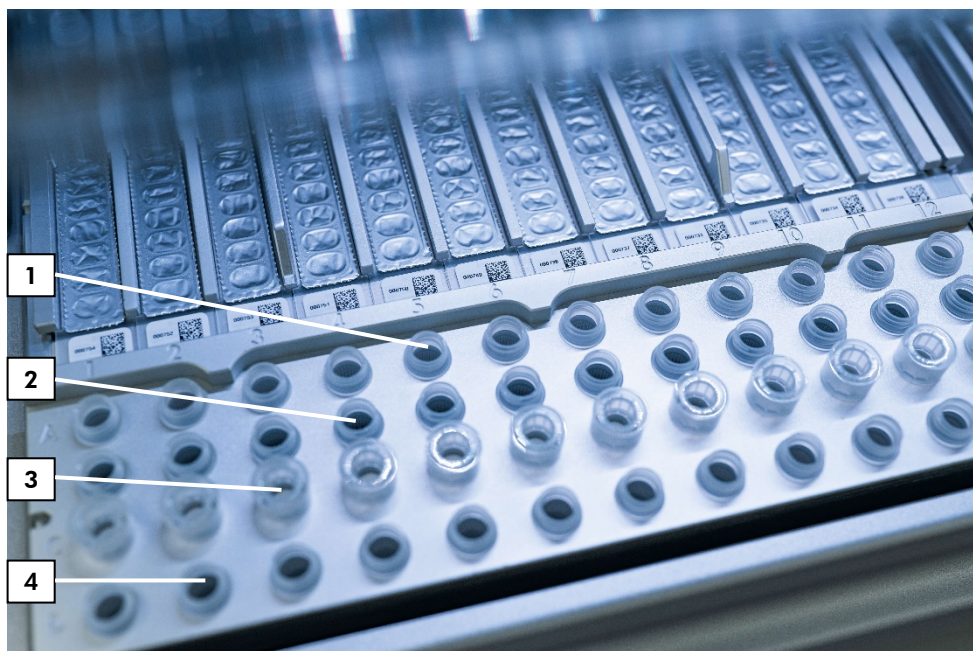
Ryc. 5. Stół roboczy aparatu EZ2 Connect MDx. (1) próbki na próbki (sample tube, ST) (2 ml) załadowane w rzędzie A, (2) rząd B pozostaje pusty lub opcjonalnie są w nim załadowane próbki (2 ml) zawierające 80-procentowy etanol przeznaczony do opcjonalnego kroku płukania, (3) jednorazowe uchwyty na końcówki (disposable tip holder, DTH) zawierające jednorazowe końcówki z filtrem (disposable filter-tip, DFT) załadowane w rzędzie C, (4) próbki do elucji (elution tube, ET) (1,5 ml) załadowane w rzędzie D
