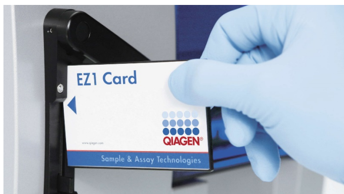
Ryc. 6. Łatwa konfiguracja protokołu z użyciem kart EZ1 DSP Card. Umieszczanie karty EZ1 Card ze wstępnie zaprogramowanym protokołem w aparacie EZ1.
