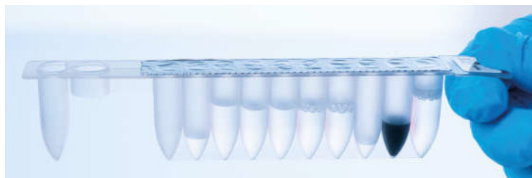
Ryc. 8. Kasecja z odczynnikami (RCB). Szczelnie zamknięta i wstępnie napełniona kasecja RCB z zestawu EZ1 DSP DNA Blood Kit.
