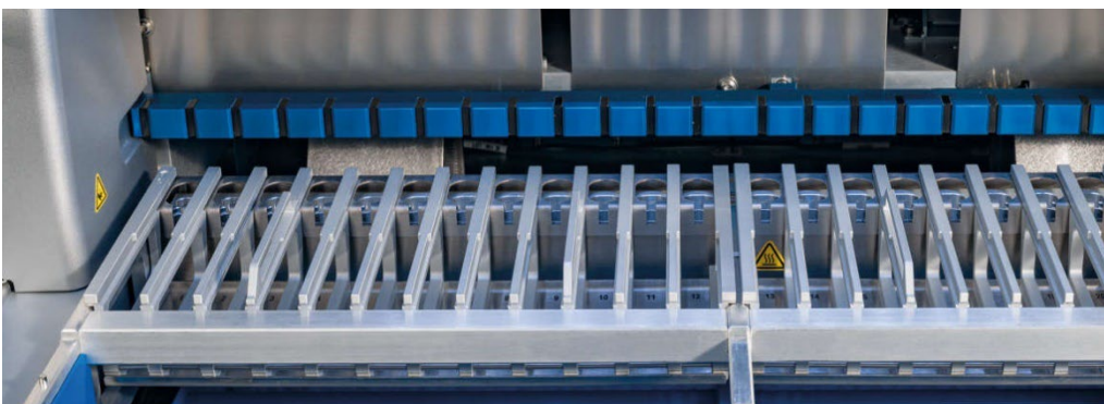
Figure 12. Portoir à cartouches amovible à l'intérieur de l'instrument.
