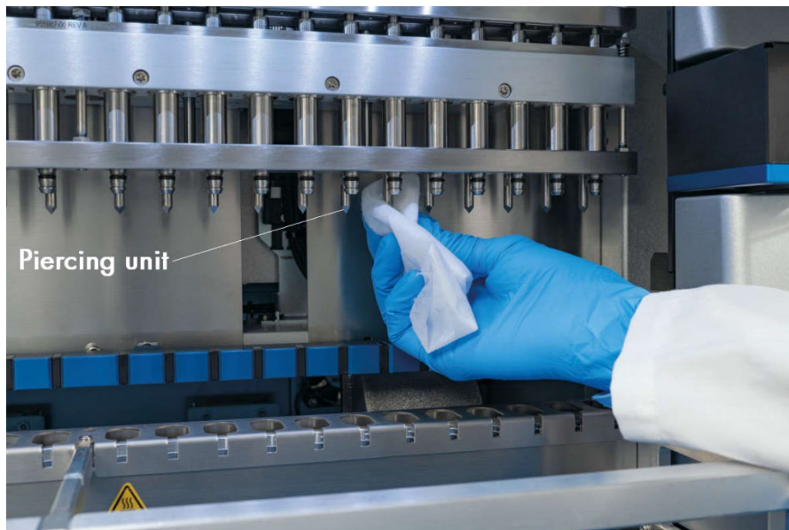
Figure 174. Nettoyage de l'unité de perforation de l'instrument EZ2.
