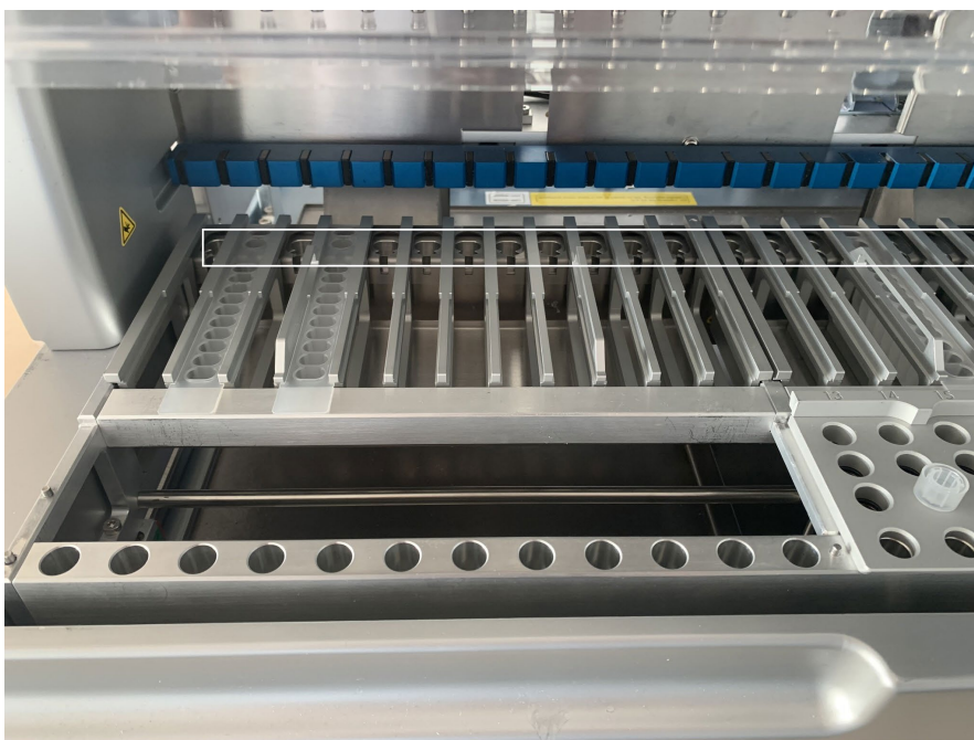
Figure 17. Positions chauffables dans le portoir à cartouches (mises en évidence par un cadre blanc).
