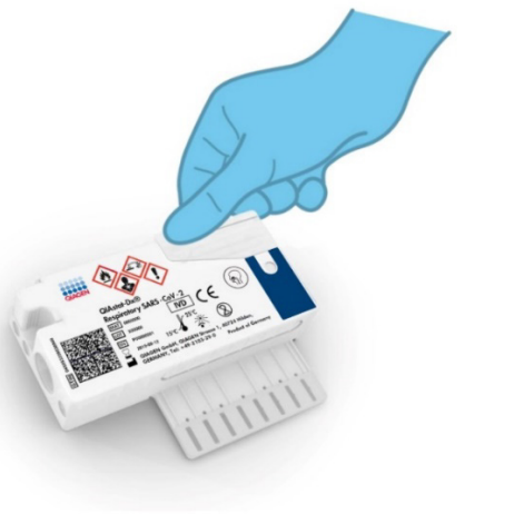
图 42.关闭主口的样本盖。
