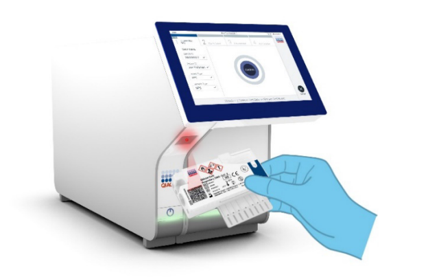
45 pav. „QIAstat-Dx Respiratory SARS-CoV-2 Panel“ kasetės brūkšninio kodo nuskaitymas.
