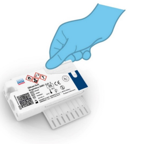
42 pav. Pagrindinės angos mėginio dangčio uždarymas.
