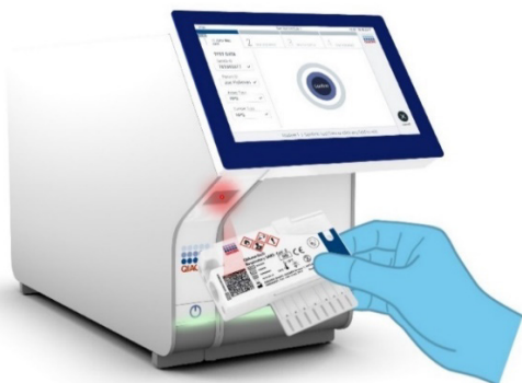
12 pav. „QIAstat-Dx Respiratory SARS-CoV-2 Panel” kasetės brūkšninio kodo nuskaitymas.
