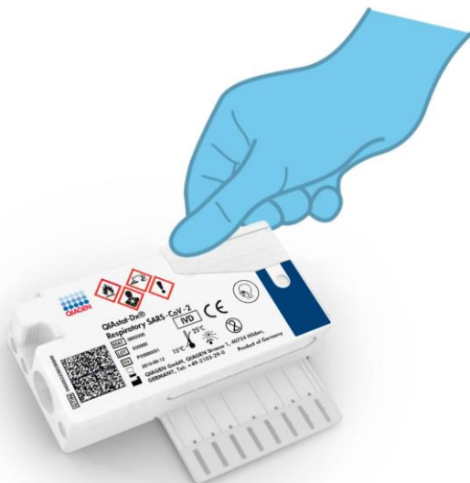
22-сурет. Негізгі порттың үлгі қақпағын жабу.
