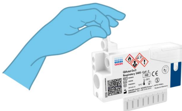
7-сурет. Тампон портының үлгі қақпағын ашу.
