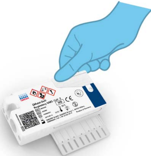
Kuva 22. Pääaukon näytekannen sulkeminen.
