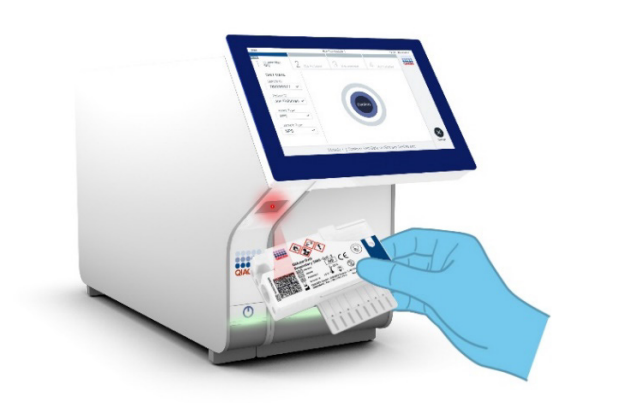
Ryc. 45. Skanowanie kodu kreskowego kasety QIAstat-Dx Respiratory SARS-CoV-2 Panel Cartridge.
