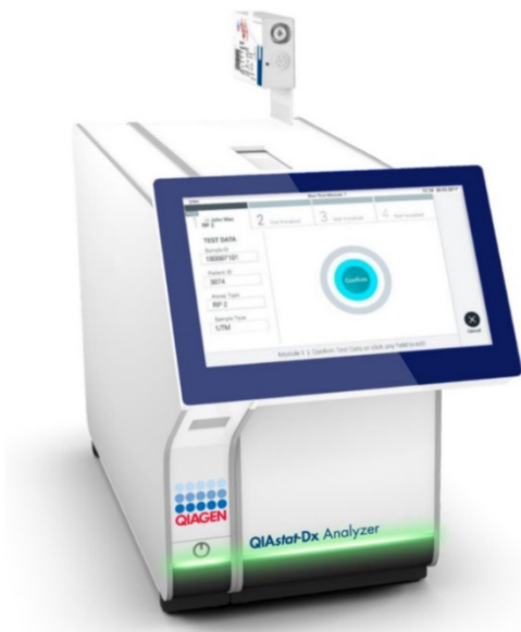
Ryc. 48. Wprowadzanie kasety QIAstat-Dx Respiratory SARS-CoV-2 Panel Cartridge do analizatora QIAstat-Dx Analyzer 1.0 lub analizatora QIAstat-Dx Analyzer 2.0.
