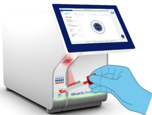
Ryc. 44. Skanowanie kodu kreskowego identyfikatora próbki.
