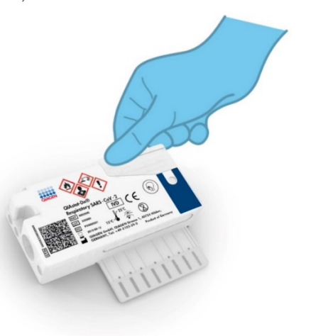
Ryc. 42. Zamykanie pokrywki próbek portu głównego.
