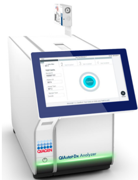
Ryc. 15. Wprowadzanie kasety QIAstat-Dx Respiratory SARS-CoV-2 Panel Cartridge do analizatora QIAstat-Dx Analyzer 1.0 lub analizatora QIAstat-Dx Analyzer 2.0.
