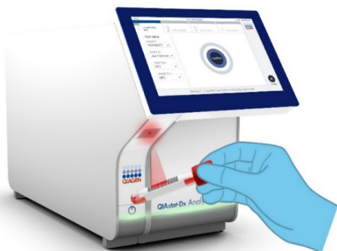
Ryc. 11. Skanowanie kodu kreskowego identyfikatora próbki.
