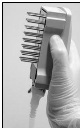
Imagem 3. Ilustração da ferramenta de vácuo levantada acima de 90° na vertical.
