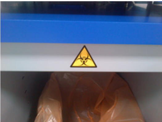
* Vị trí của nhãn cảnh báo nguy cơ sinh học trên điều khiển tủ máy (SP).
