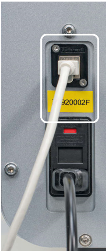
Figura 6. Ubicación del puerto RJ-45 (marcado con un marco blanco).
