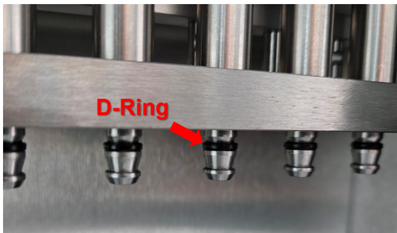
Figura 177. Adaptador de puntas con anillo en D resaltado.
