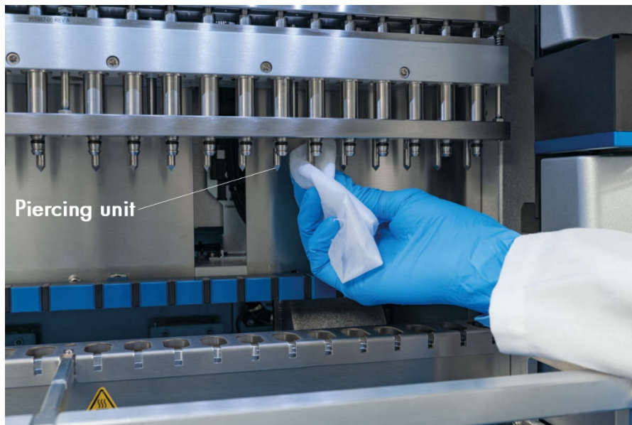
Figura 174. Limpieza de la unidad de perforación del EZ2.
