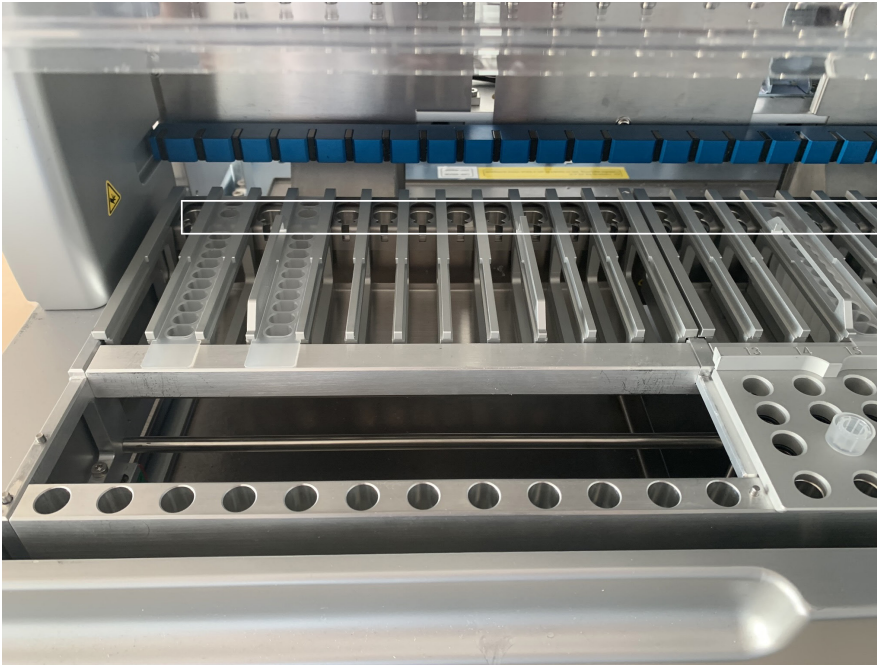
Figura 17. Posiciones calefactables en la gradilla de cartuchos (marcadas con un marco blanco).
