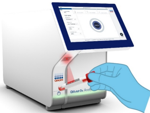
Εικόνα 44. Σάρωση γραμμωτού κωδικού αναγνωριστικού δείγματος.
