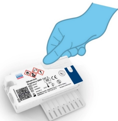
Εικόνα 42. Κλείσιμο του καπακιού δείγματος της κύριας θύρας.
