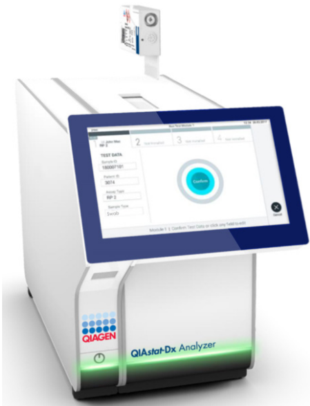
Εικόνα 15. Εισαγωγή φύσιγγας QIAstat-Dx Respiratory SARS-CoV-2 Panel Cartridge στον αναλυτή QIAstat-Dx Analyzer 1.0 ή στον αναλυτή QIAstat-Dx Analyzer 2.0.
