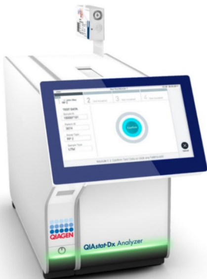
Εικόνα 48. Εισαγωγή φύσιγγας QIAstat-Dx Respiratory SARS-CoV-2 Panel Cartridge στον αναλυτή QIAstat-Dx Analyzer 1.0 ή στον αναλυτή QIAstat-Dx Analyzer 2.0.
