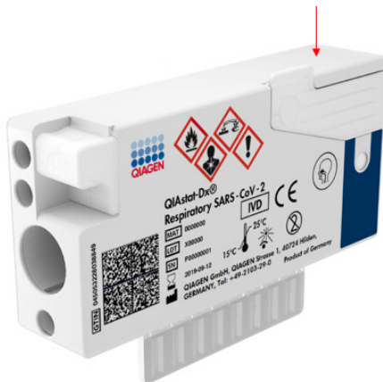
Εικόνα 51. Τοποθέτηση γραμμωτού κωδικού αναγνωριστικού δείγματος
