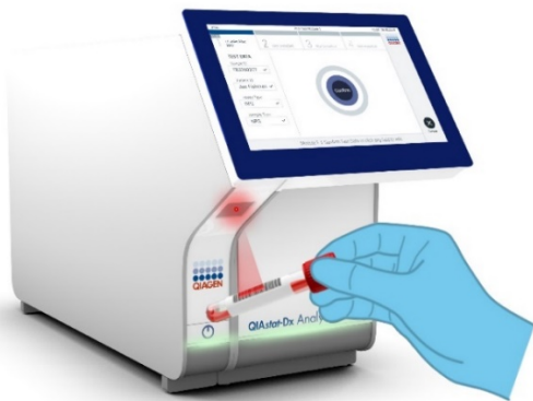
Εικόνα 11. Σάρωση γραμμωτού κωδικού αναγνωριστικού δείγματος.
