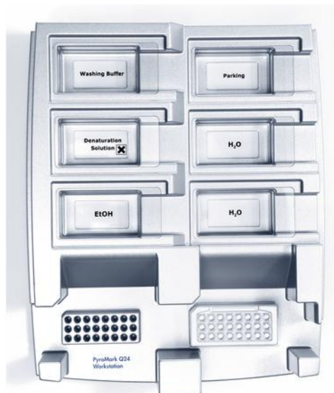
Abbildung 3. Position der PCR-Platte und der PyroMark Q24 Platte in der Vakuum-Arbeitsstation
