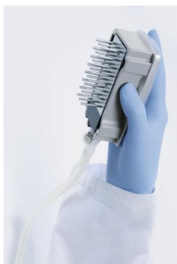
Abbildung 4. Saugkopf über die Senkrechte hinaus geschwenkt (über 90°)
