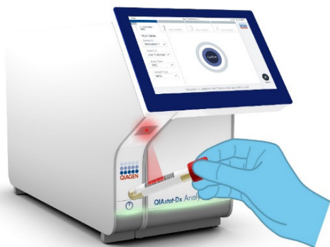
Slika 10. Očitavanje crtičnog koda ID-ja uzorka.
