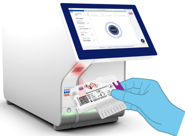
Slika 11. Očitavanje crtičnog koda uložka QIAstat-Dx Gastrointestinal Panel 2 Cartridge.
