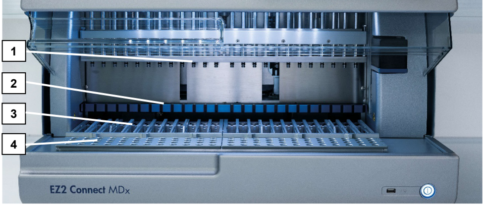
Şekil 4. EZ2 Connect MDx cihazına genel bakış. (1) Pipetleyici kafa, (2) mıknatıs modülü, (3) kartuş rafı ve (4) uç rafı (laboratuvar gereci tutucu).
