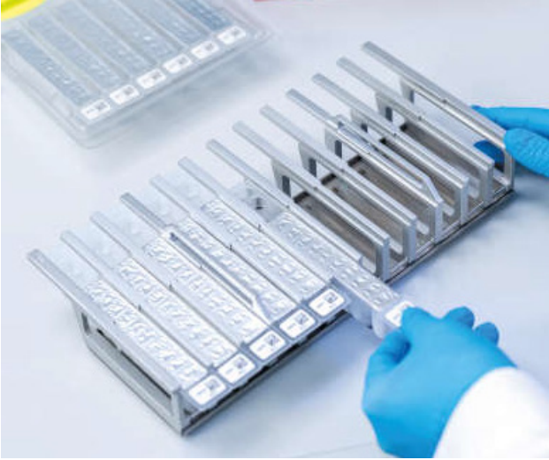
Şekil 3. Reaktif kartuşu rafı. Kartuş rafı, reaktif kartuşlarının (RCV) yüklenmesi gereken yönü gösteren bir ok ile etiketlenmiştir.
