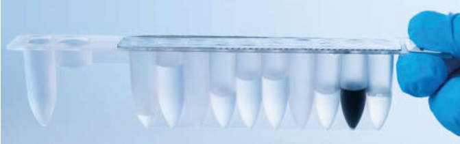
Şekil 8. Reaktif kartuşu (RCV). EZ1 DSP Virus Kit'in mühürlü, önceden doldurulmuş RCV'si.
