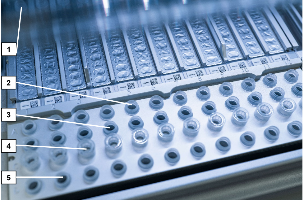
Şekil 5. EZ2 Connect MDx cihazının çalışma tablası. (1) Reaktif kartuşlarında (RCV) yüklü 2 ml'lik tüpler (ST) ile lizis amaçlı ısıtma bloğu. (2) A satırına yüklenen örnek tüpleri (ST) (2 ml). (3) B satırına yüklenen, elüsyon tamponunda (AVE) taşıyıcı RNA (CARRIER) ve dahili kontrol (Internal Control, IC) (kullanılıyorsa) içeren tüp (ET) (1,5 ml). (4) C satırına yüklenen, tek kullanımlık filtre uçları (DFT) içeren tek kullanımlık uç tutucular (DTH). (5) D satırına yüklenen elüsyon tüpleri (ET) (1,5 ml).
