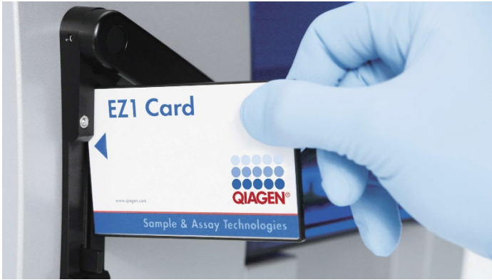
Şekil 6. EZ1 DSP Card'lar kullanılarak protokol kurulum kolaylığı. Protokol ile önceden programlanmış bir EZ1 Card'ı EZ1 cihazına yerleştirme.
